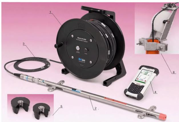
Рисунок 5 - Портативный инклинометрический измерительный комплект
