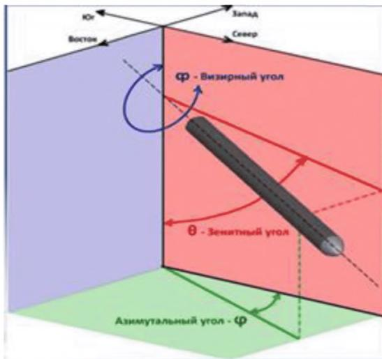
Рисунок 3 - Принципиальная схема инклинометрических измерений при бурении скважин
