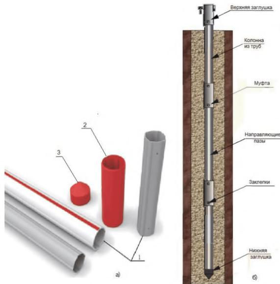
а) 1-труба, 2-соединительная муфта, 3-заглушка б) колонна в сборе
