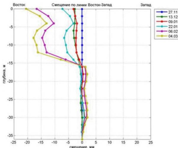
Рисунок 11 - Результаты измерения сползания склона по оси запад-восток
