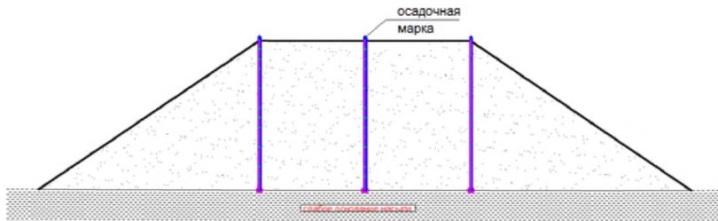
Рисунок 2 - Расстановка осадочных марок для снятия одного поперечника
