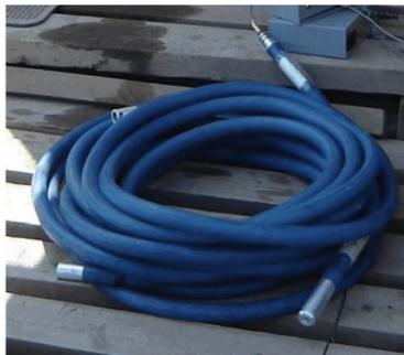
Рисунок 10 - Массив инклинометрических датчиков в форме гибкой сборки
