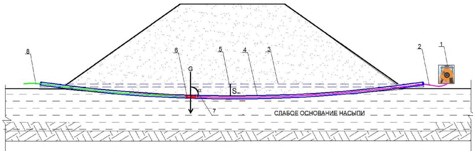
1- портативный инклинометрический комплект; 2-кабель инклинометра; 3-первоначальное положение измерительного канала; 4- инклинометрический измерительный канал после осадки насыпи; 5-осадка насыпи; 6-инклинометр; 7 – измеряемый угол наклона; 8 - протяжной шнур
