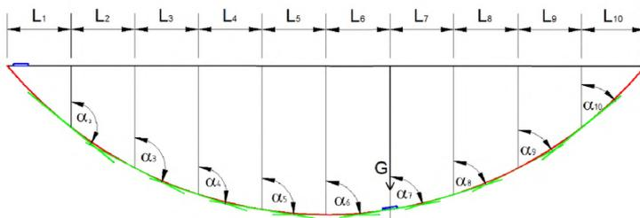
Рисунок 12 - Схема измерения осадок насыпи инклинометром
