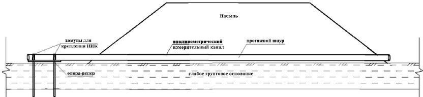
Рисунок 15 - Оборудование измерительного канала
