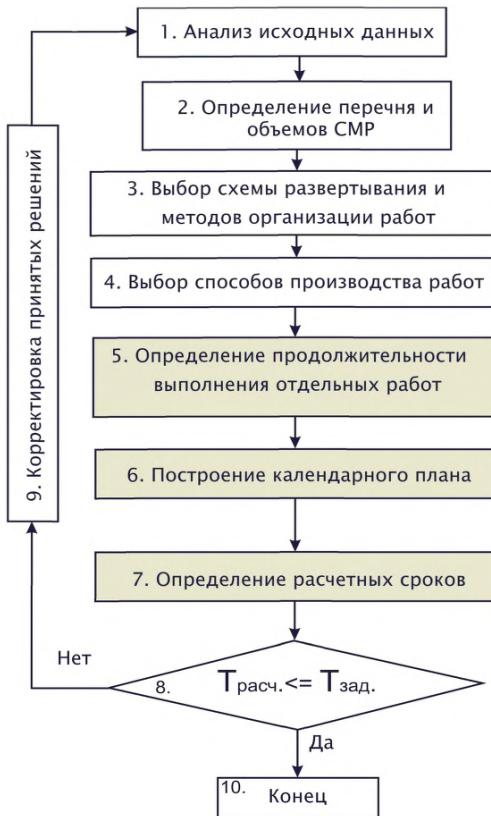
Рисунок 1 – Общая схема разработки календарного графика
