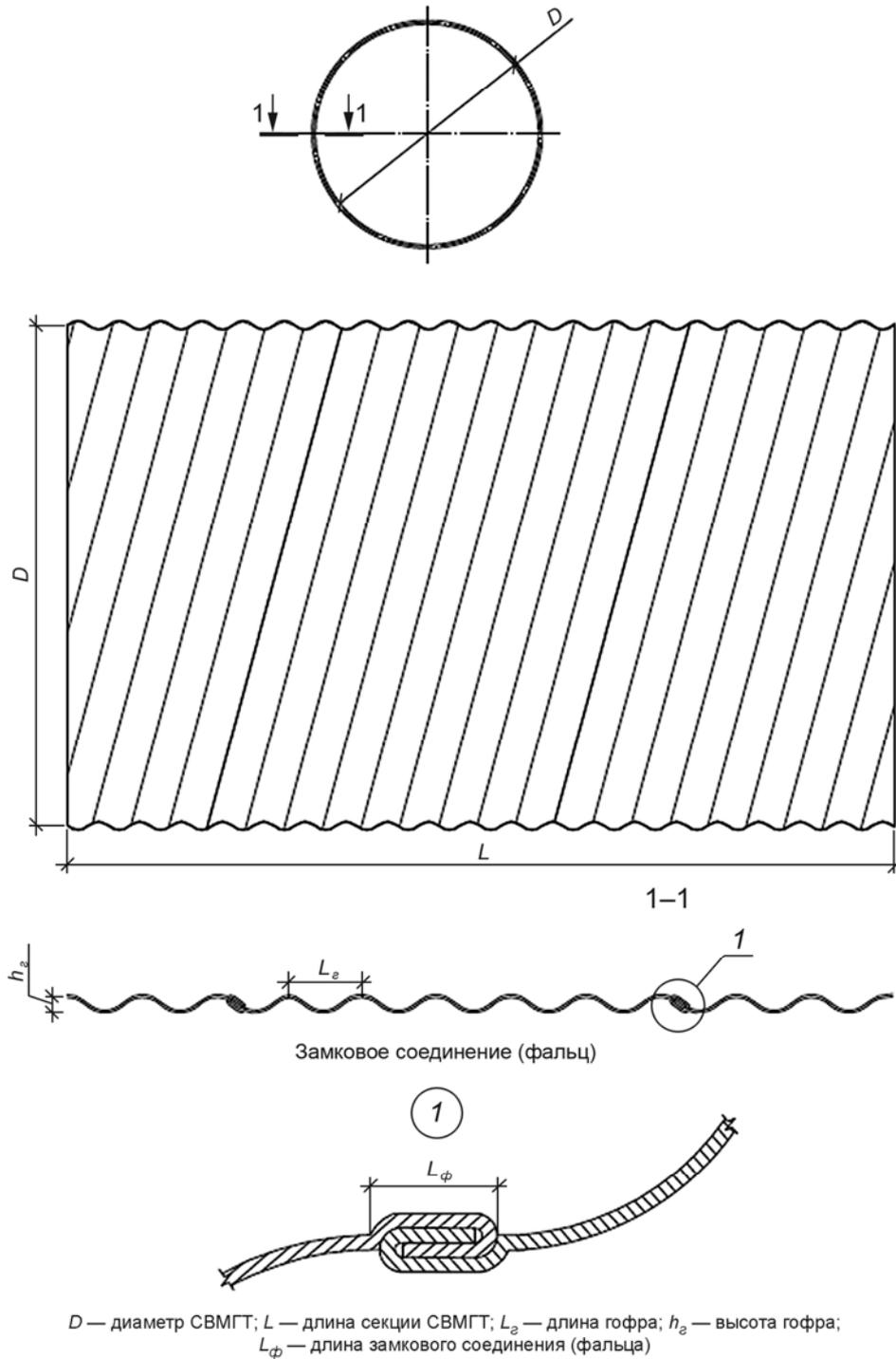
Рисунок А.1 — Конфигурация и геометрические размеры СВМГТ
