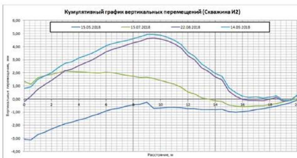
Рисунок 16 - Пример таблицы и графика инклинометрических измерений осадок насыпи
