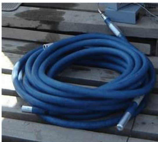
Рисунок 10 - Массив инклинометрических датчиков в форме гибкой сборки
