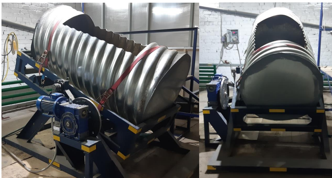
Рисунок А.1 – Пример общего вида установки для проведения испытаний СВМГТ на гидроабразивный износ
